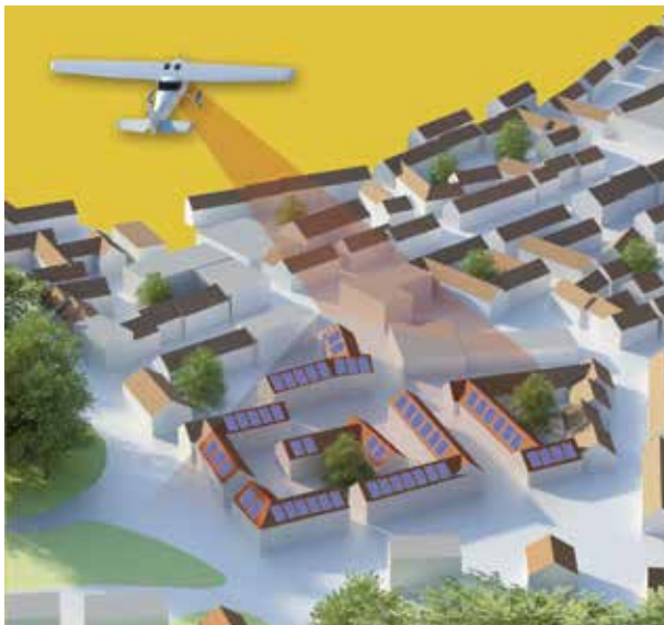
Abb. 5: Befliegung zur Aufnahme von Laserscan-Daten
